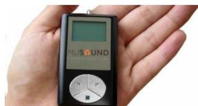
AUDIORICEVENTI® MOD. GOLD Piccola e leggerissima Scocca in metallo Progettazione PLL sintetizzato 32 canali disponibili Circuito dual-squelch Display LCD bianco 96x64 Suono qualità digitale Speciale batteria agli ioni di litio che rispetta l'ambiente
